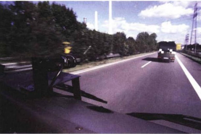
Figure 1 e 2 - Daimler-Benz, in collaborazione con IVECO, ha implementato il proprio sistema di guida automatica anche su TIR allo scopo di sperimentarne le caratteristiche e le potenzialità con i professionisti della strada. Nella prima foto si nota il PC portatile che funge da interfaccia col guidatore impegnato, come si vede, a leggere una rivista. Nella seconda foto si nota il dettaglio su una delle telecamere anteriori: a bordo se ne possono contare ben 18.
